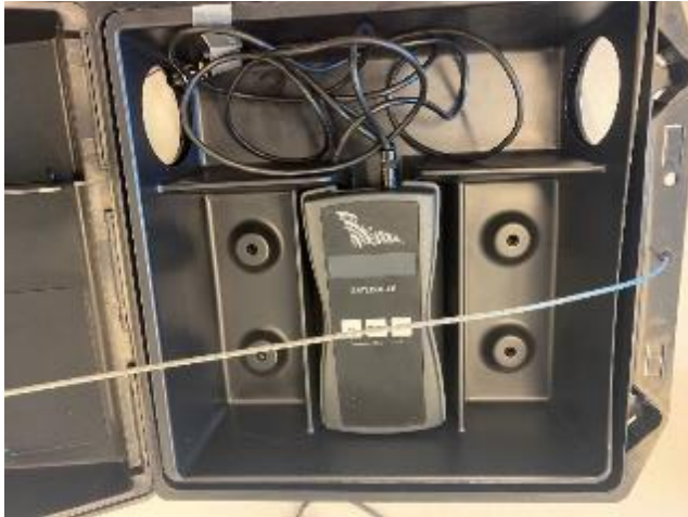
Figuur 6. Batlogger bevestigd in rattenlokdoos.
