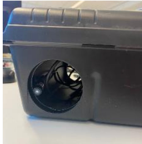
Figuur 7. Microfoon bevestigd in rattenlokdoos.
